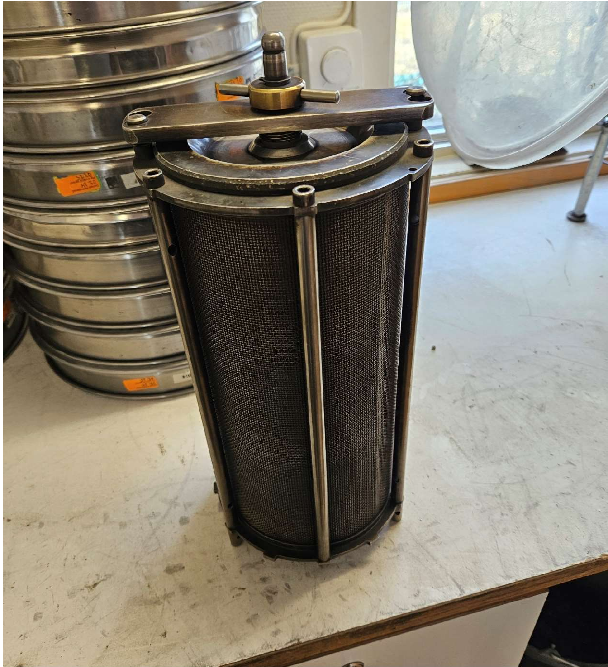
Figur 2 Provbehållare som fylls med nedsmulad asfalt, metylenklorid kan sedan rinna in igenom behållarens nätbeklädda sidor, för att lösa upp bituminet i provet.
