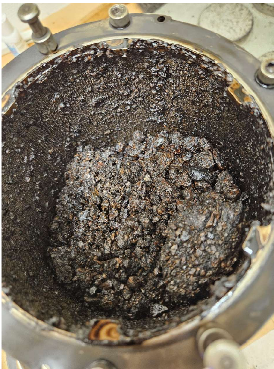
Figur 3. Asfaltprov efter två tvättcykler med 4,5 kg provmängd.
